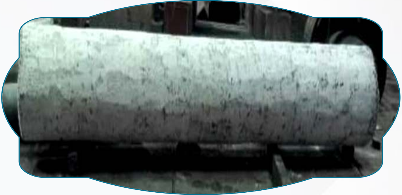
Zircaloy tubes OD 570 X ID 395 X L 3500 mm
